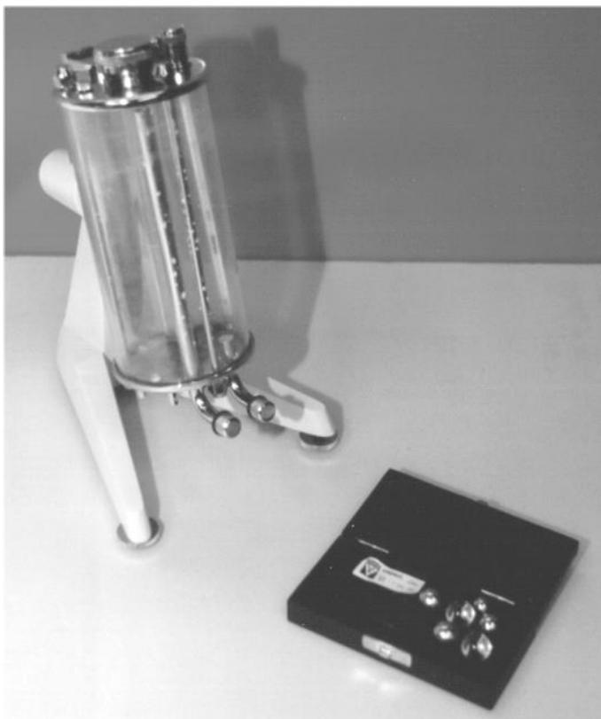
**Abb.VII-5:** Kugelfall-Viskosimeter und Kugeln
