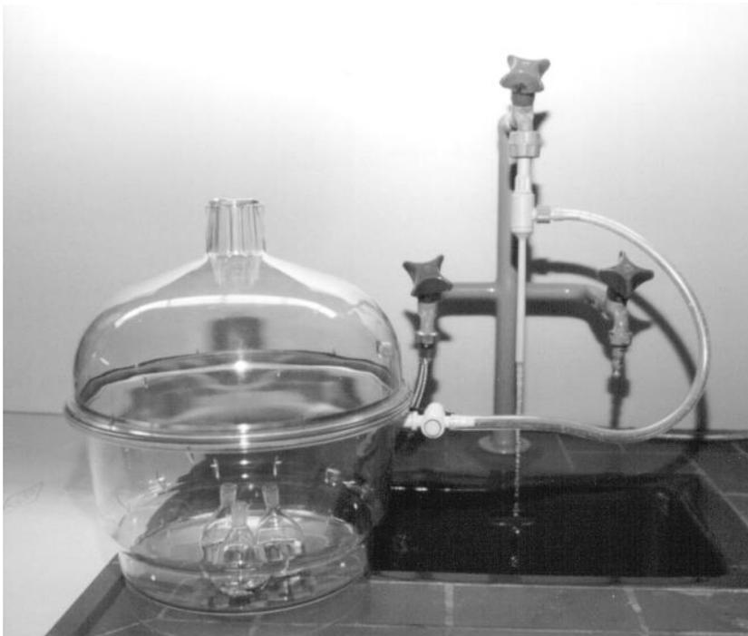
**Abb.III-7:** Exsikkator mit Wasserstrahlpumpe
