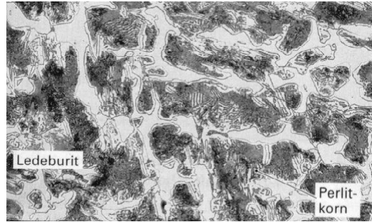
Abb.15: Temperrohrguss (2,8% C) nach rascher Abkühlung. M500:1
