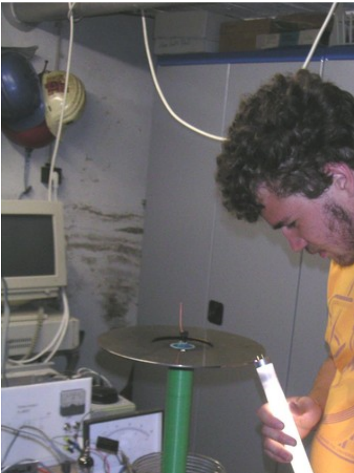
Eine Neonröhre leuchtet bei richtiger Abstimmung schon in einigen cm Abstand hell auf:
