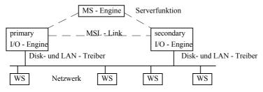
Kommunikation vom Client findet nur über die Primary I/O-Engine mit der MS-Engine statt, die Secondary I/O Engine wird über das MSL Link auf dem Laufenden gehalten. Im Fehlerfall des Primary Servers kann die Secondary Server die Verbindung zur MS-Engine herstellen. Um sicherzustellen, daß der Secondary Server unterscheiden kann, ob wirklich ein Ausfall des Primary Servers vorliegt oder ein Ausfall der MSL Verbindung, tauschen beide Server ständig über das LAN sogenannte I'm Alive Pakete aus.
