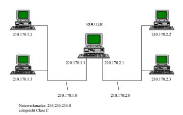
Jeder Netzwerkkarte in jedem Host wird eine eigene IP Nummer zugeteilt, die beiden Teilnetze erhalten z.B. die Nummern 210.170.1.0 bzw 210.170.2.0. Die 0 kennzeichnet das jeweilige Netzwerksegment, die Nummer 1 bis 254 sind für die Rechner im jeweiligen Segment vorgesehen.
