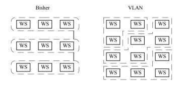
VLAN: Logische Ebene von physikalischer Ebene völlig getrennt. Bisher war die Voraussetzung einer logischen Trennung von Netzen (via Router) zwangsläufig eine physikalische Trennung von Netzen (über eben diese Router). Durch Level-3 Switching können innerhalb eines Switches mehrere log. Netze koexistieren. Damit sind z.B. physikalische Änderungen des Netzes bei Änderung der Arbeitsgruppen innerhalb eines Netzes nicht mehr nötig.
