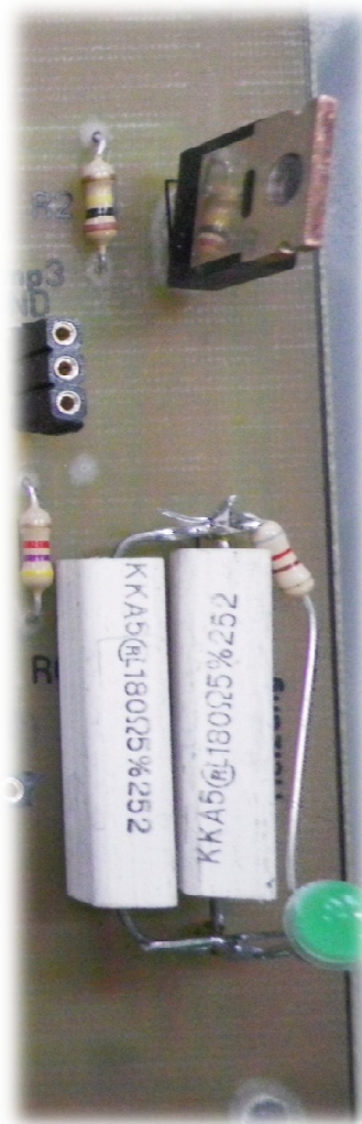
Abb. 49: Foto der Heizung.
