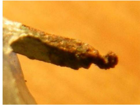
Rechts ist zu sehen, dass der Anschlusspin nach einer Betriebszeit von wenigen Wochen so stark korrodiert wurde, dass die Verbindung aufgetrennt war.
