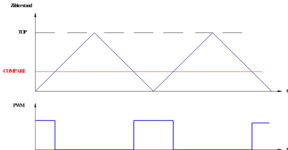
Durch Verändern des Compare-Wertes kann die Impulsdauer länger oder kürzer gemacht werden.
