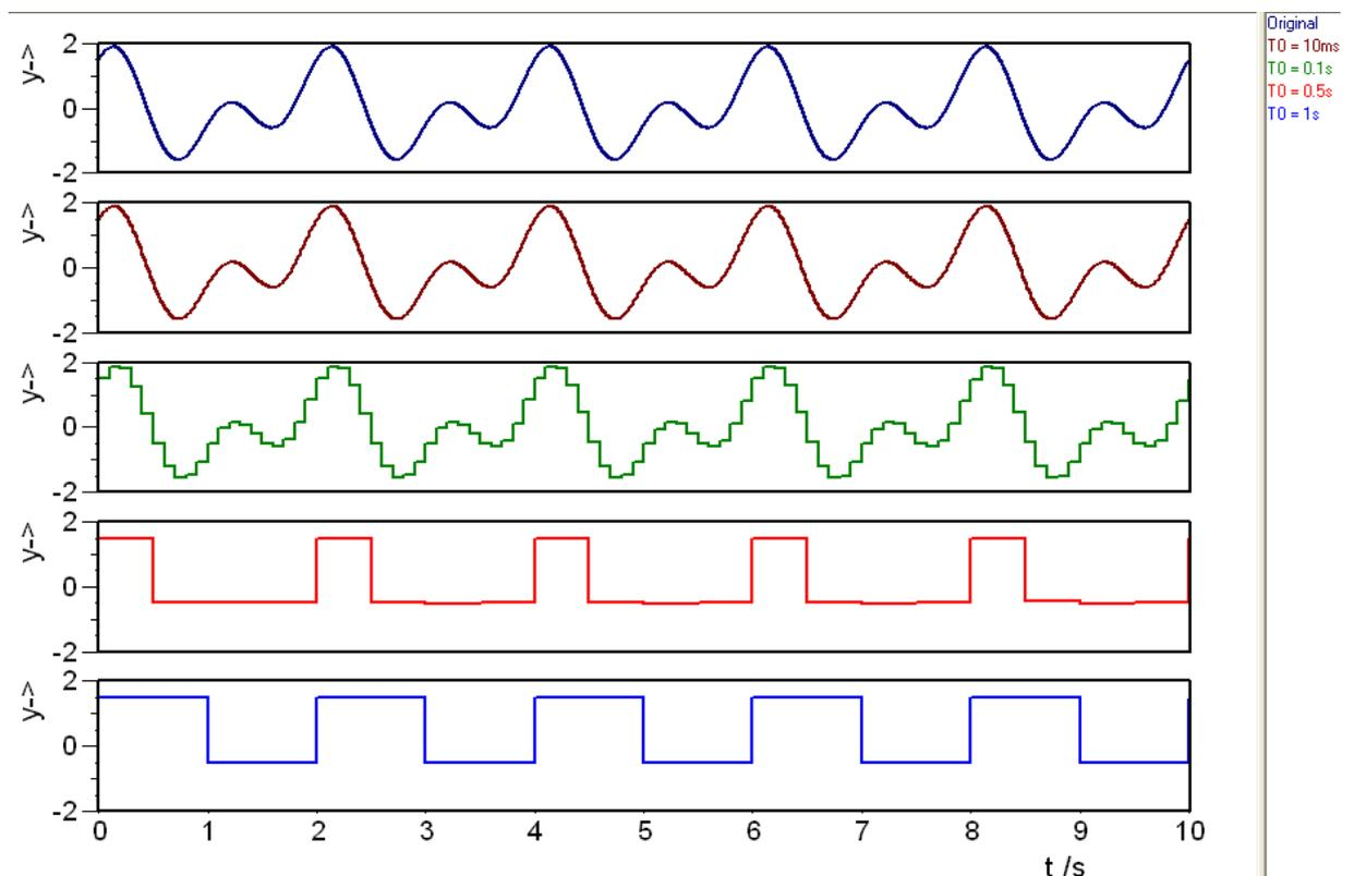
Nach Shannon sollten wir mit mindestens 2Hz, also  $T_{0\text{min}} = 0.5\text{s}$  abtasten. Das Ergebnis dieser Minimalforderung ist aber recht kläglich, während noch längere Abtastzeiten schlimme Fehler produzieren.
