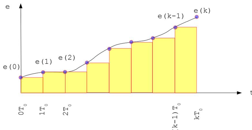
$$y(k) = \frac{1}{T_I} \cdot [e(0)T_0 + e(1)T_0 + \dots + e(k-2)T_0 + e(k-1)T_0]$$
