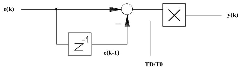
Dabei bedeutet der  $z^{-1}$  – Block eine Verzögerung um einen Takt. Dies entspricht der Verwendung eines abgespeicherten Wertes  $e(k-1)$
