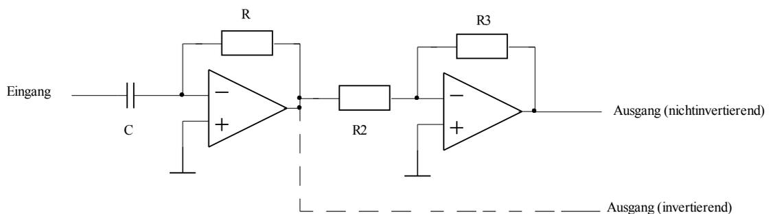
Beispiel:  $R = 1\text{M}\Omega$ ,  $C = 3.3\mu\text{F}$ ,  $R_2 = 100\text{k}\Omega$ ,  $R_3 = 100\text{k}\Omega$ .
