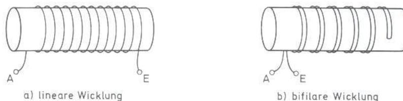
Die **bifilare Wicklung** hat eine sehr geringe Induktivität, daher ist auch eine Messung an Wechselspannung möglich.
