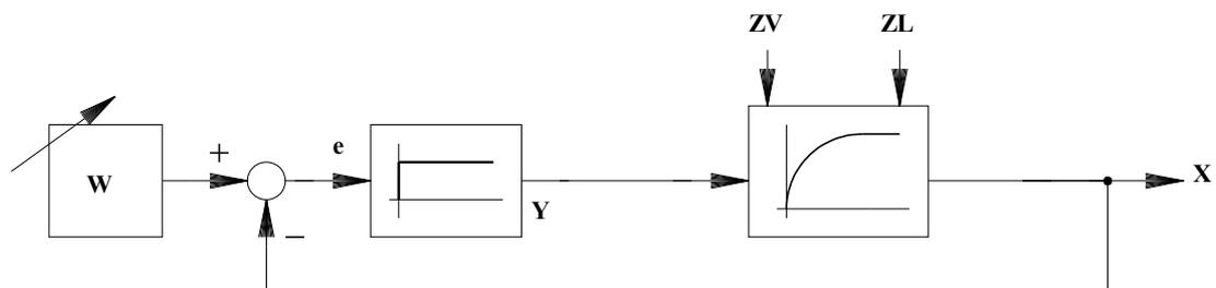
$Z_L$  = Laststörung, wirkt am Ausgang der Strecke
