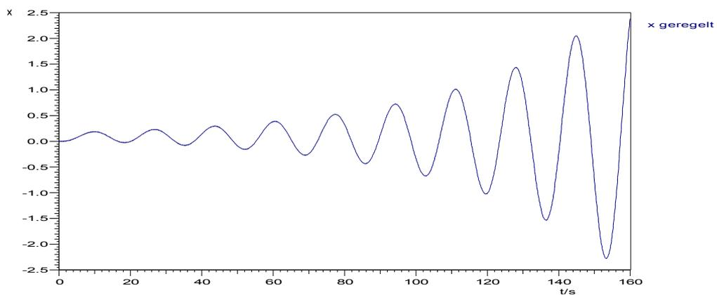
Bei P-Reglern ist Instabilität erst möglich bei P-Strecken ab 3. Ordnung und bei einer großen Verstärkung des Reglers.
