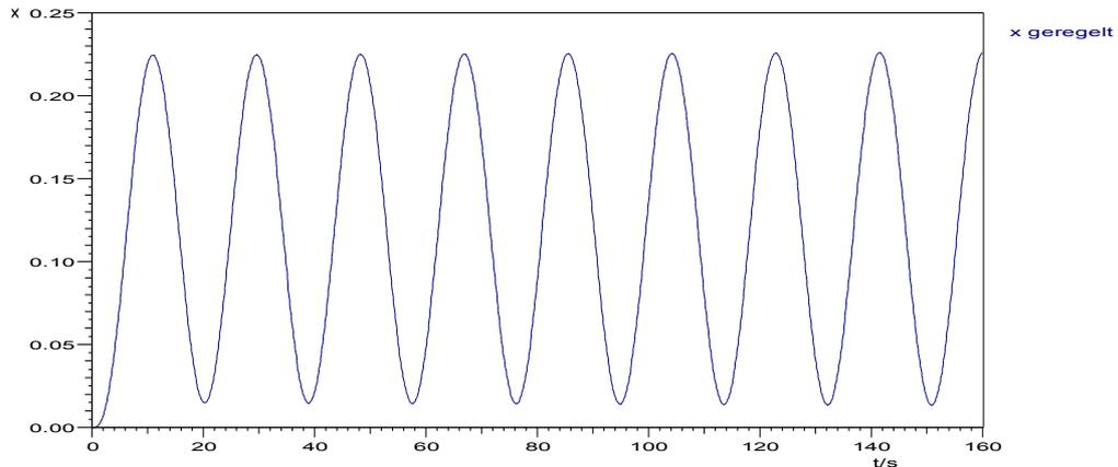
Der P-Bereich  $X_P$  (bzw. der P-Beiwert  $K_{PR}$ ) bei dem die Stabilitätsgrenze erreicht ist, wird als **kritischer P-Bereich**  $X_{Pkrit}$  (bzw. kritischer P-Beiwert oder kritische Verstärkung) bezeichnet.
