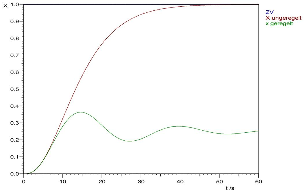
Nach einer Störung am Eingang der Strecke dauert es ca.  $T_u$  bis sich die Regelgröße am Messort ändert, Dann dauert es noch einmal ca.  $T_u$  bis sich das Eingreifen des Reglers am Messort bemerkbar macht.
