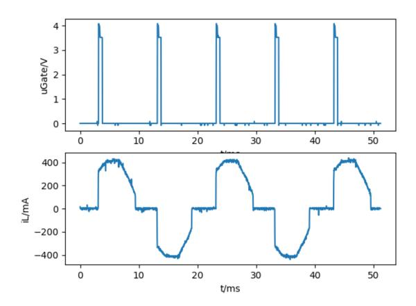
Man sieht im Oszillogramm übrigens deutlich dass der Triac löscht wenn der Haltestrom von ca. 100mA unterschritten wird Es wurde bei dieser Messung hier ein "fetter" Doppelthyristor SKKT56/120 und als relativ schwache Last eine 100W Glühbirne an 110V verwendet. Die Ansteuerung erfolgte mit 2 Impulstrafos für die galvanische Trennung. Diese Trafos wurden aus Computernetzteilen recycelt (1:1, 4.7mH). Der Strom wurde als Spannungsabfall an einem 1 Ohm-Shuntwiderstand gemessen.
