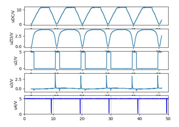
uDC: gleichgerichtete aber ungesiebte Spannung
