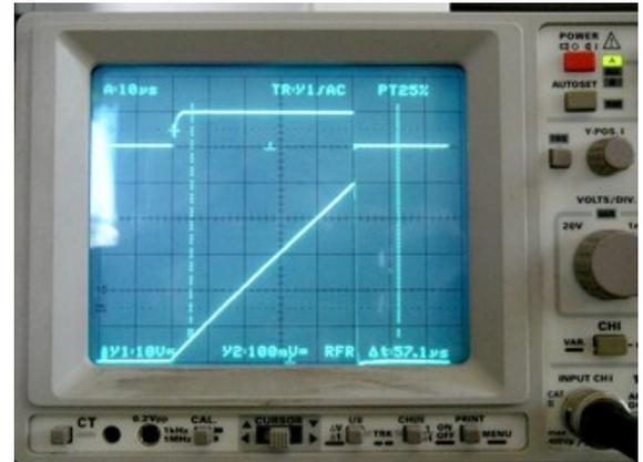
Im obigen Bild wurde auf dem ersten Kanal der Steuerimpuls (ca. 10Vss) und auf dem zweiten Kanal der Strom dargestellt (1DIV = 100mV, entsprechend 1A).
