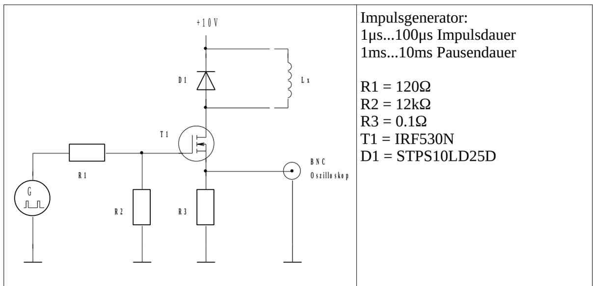
Der Transistor schaltet die Spule kurz ein, dabei fließt bis zur Sättigung ein linear ansteigender Strom. Bei Beginn der Sättigung steigt der Strom überproportional an.
