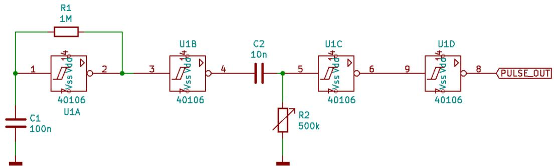
Diese besteht aus Rechteckgenerator, einstellbarem Differenzierglied und Schmitttrigger als Impulsformer. Frequenz und Impulsdauer lassen sich in weiten Grenzen variieren.
